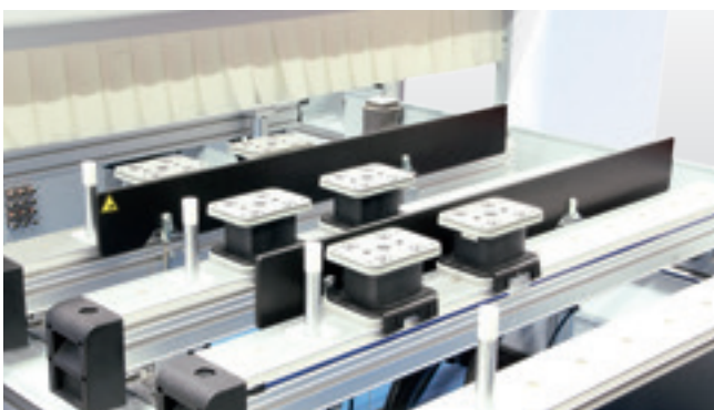
Werkstückeinlegehilfen Robuste Einlegehilfen zum Belegen schwerer Werkstücke mit 2 Pneumatikzylindern
