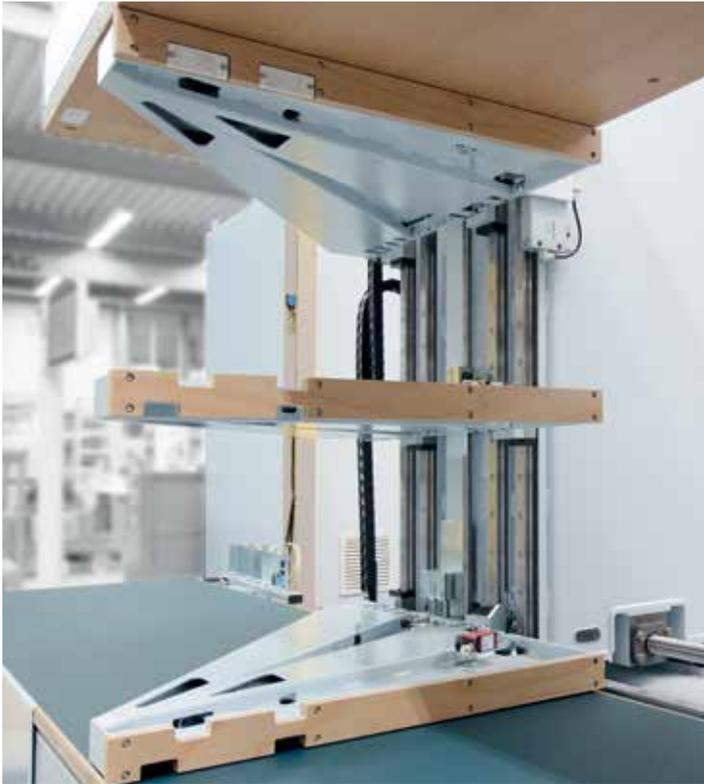
**Seitliche Druckwangen:** Die Druckwangen funktionieren wie eine Einheit. Die Presskräfte werden elektrisch erzeugt und sind separat variierbar. Sie werden vertikal durch eine Druckplatte und horizontal durch je 3 Druckwangen aufgebracht.
