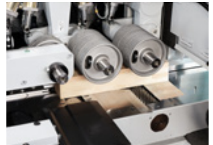
Kurzteile ab 300 mm möglich
