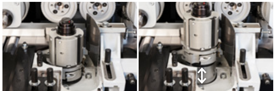
Axiale Verstellung an den vertikalen Spindeln bis zu 75 mm
