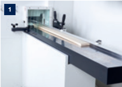
Verchromter Abrichttisch manuell einstellbar
