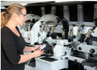
Ergonomisches Handterminal für die schnelle und automatische Ausrichtung ausgewählter Spindeln
