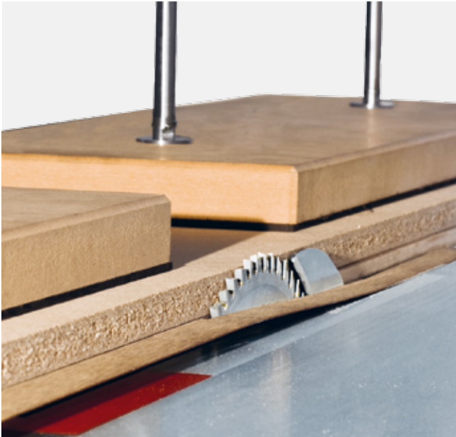
Pneumatischer Druckbalken 1,9 m
