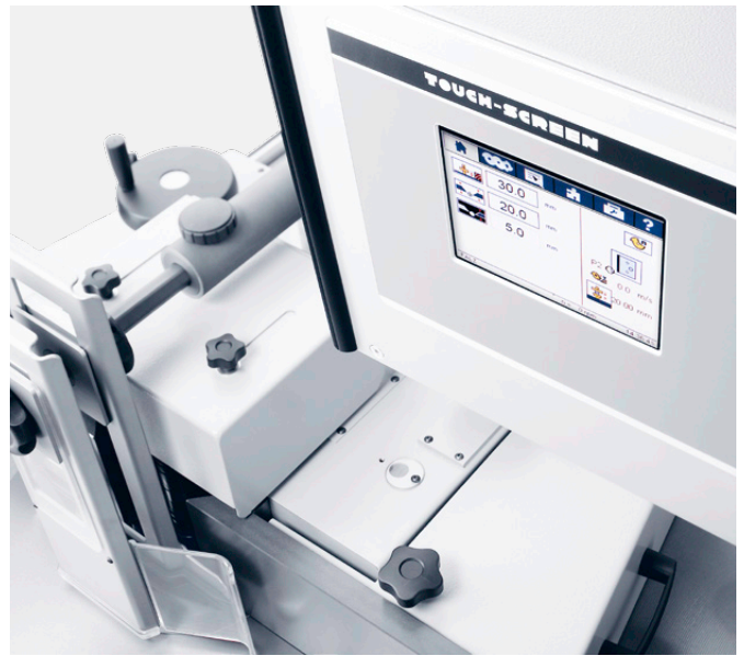
Digitale Anzeige der Position des Anschlaglineals (rechts)
