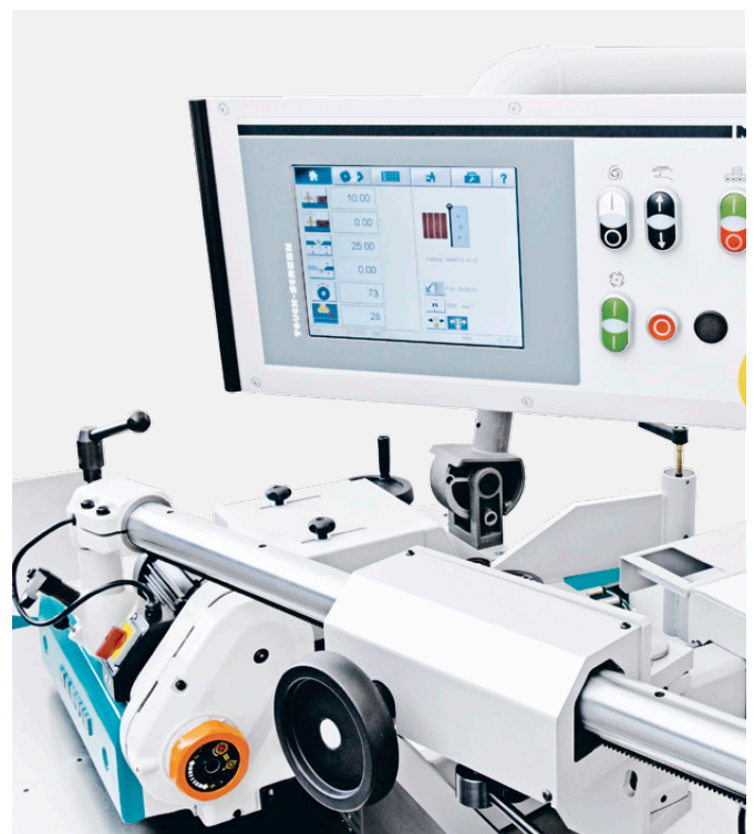
Elektromotorisch positionierbarer Vorschub-Support
