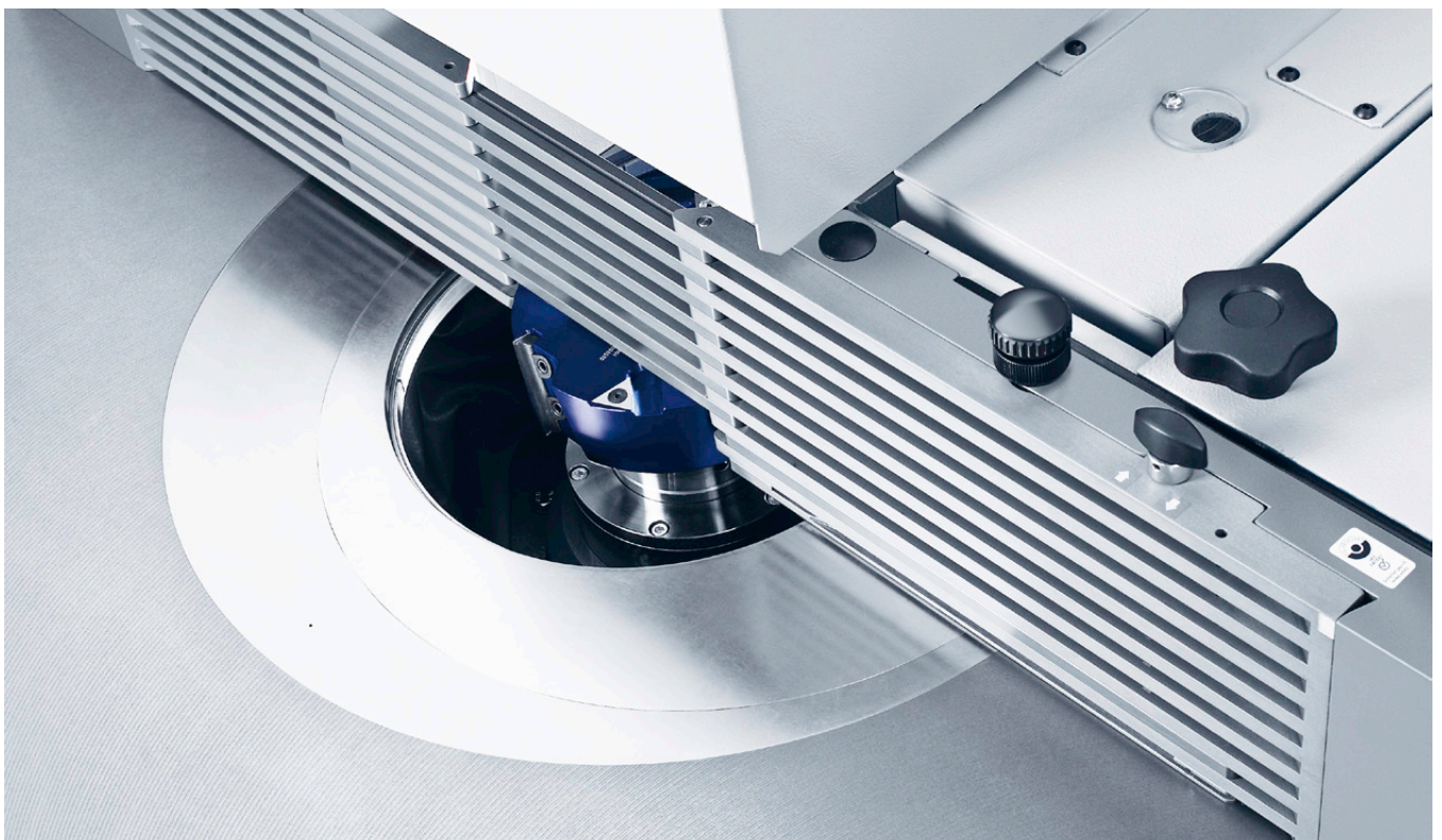
Elektromotorisch positionierbare Tischöffnung
