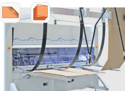
Die Kombi-Kartonagenzuführung gestattet die Zuführung von Einzelblättern sowie die Verwendung von Endloskartonagen.
