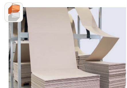
In der Betriebsart Side by Side wird das Kartonagenzuführfach um eine weitere Bahnbreite erweitert, sodass bei einem 6-Fach-Wechselsystem bis zu 12 Bahnbreiten im Einzelzugriff möglich sind.
