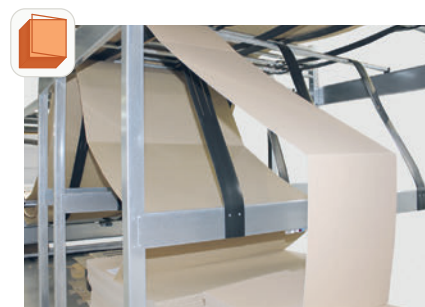
Der Endloskartonagenwechsler ist ein automatisches Wechselsystem für Endlosbahnbreiten mit bis zu sechs Fächern.
