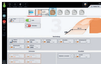
Das intelligente Restlängenmanagement reduziert Maschinenstillstandzeiten und erleichtert den Stapelwechsel.
