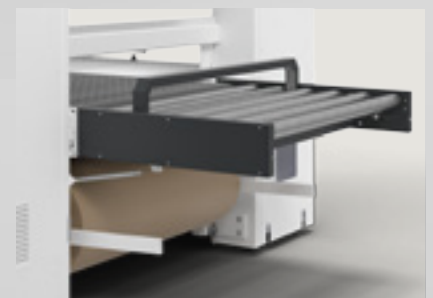
Vakuumtransport mit zusätzlicher Papierauflage. Einweg-Papier macht ein aufwendiges Transportreinigungssystem sowie das Reinigen der Maschine bei Chargenwechsel überflüssig.
