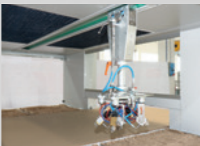
Schlittenläufer mit einem Spritzarm für vier Spritzpistolen.
