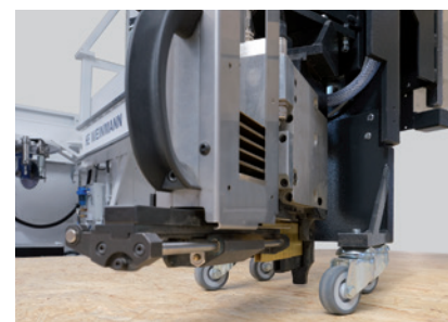
Befestigen der Beplankung
