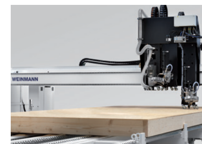
Befestigen der Beplankung
