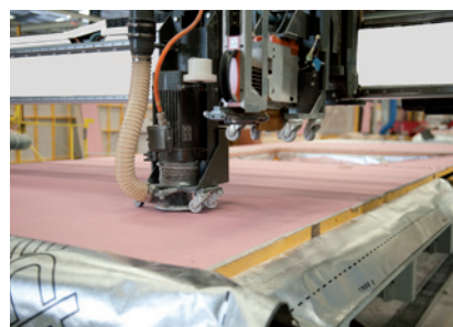
Bearbeiten von Gipskarton
