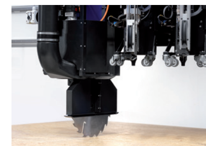
Sägeaggregat mit integrierter Schutz- und Absaughaube
