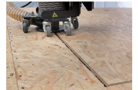
WALLTEQ M-320: Vollautomatisches Bearbeiten mit Fräsaggregat
