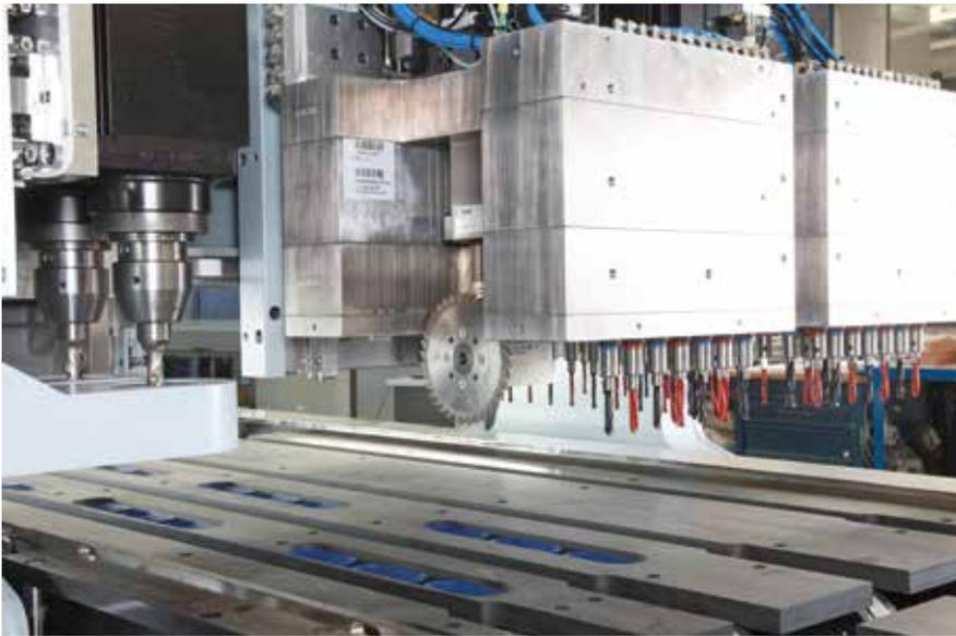
**Setzaggregat für Montageplatten**
