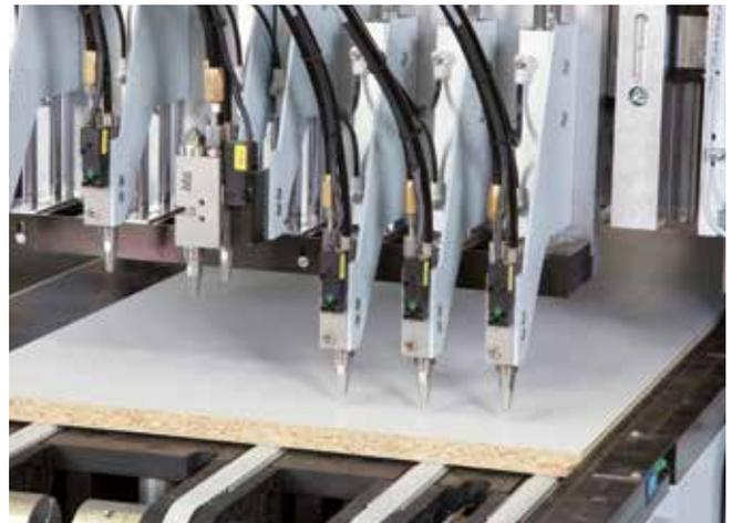
**Setz-/Schraubaggregat für Schubkastenführungen**
