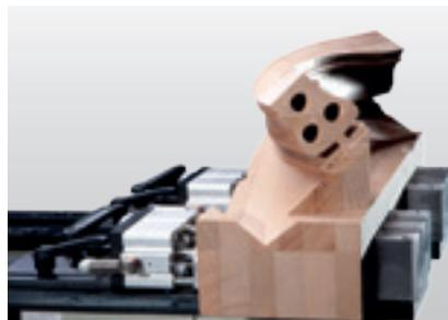
**Klemmvorrichtung:** Im Handumdrehen lassen sich Pfosten und Kanteln durch diese Klemmvorrichtung sicher spannen.
