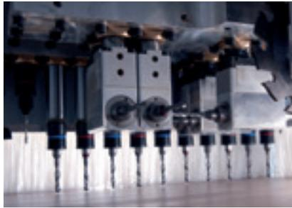
High-Speed-Bohrtechnik mit Nutsäge
