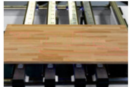
**Laserprojektion:** Laserprojektion der Spannmittel und der Werkstückkontur für optimale Ausnutzung und einfaches Auflegen von Rohteilen, die nicht an den Anschlüssen ausgerichtet werden können.
