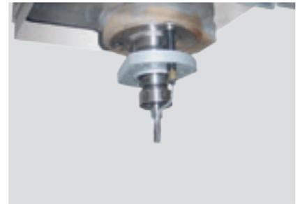
**Minimalmengenschmierung:** Aluminium bearbeiten mit Minimalmengenschmierung durch das Aggregat oder über ein externes Sprührohr an der Spindel für werkzeugschonenden Einsatz.
