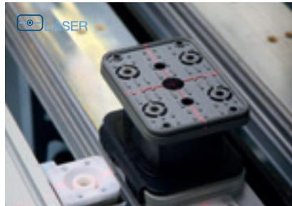
**Vakuumsauger:** Vakuumsauger werden mit einem Laserstrahl (Fadenkreuz) angezeigt. Als Positionierhilfe für Freiformteile kann die Werkstückkontur „abgefahren“ werden.
