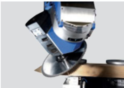
**Fünf-Achs-Frässpindel:** Kompakte DRIVE5C/+ Fünf-Achs-Spindel mit 10 kW Leistung (optional 12 oder 15 kW) und einer geregelten Spindeldrehzahl von 0 bis 24 000 1/min für ein hohes Drehmoment bereits bei geringen Drehzahlen.
