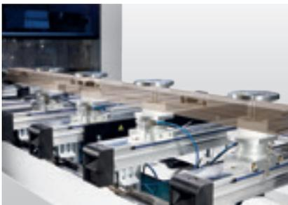
**powerClamp:** Manuelle Spannvorrichtung powerClamp für gerade und geschweifte Teile. Ideal für alle Bogen-, Schmal- und Rahmenteile.
