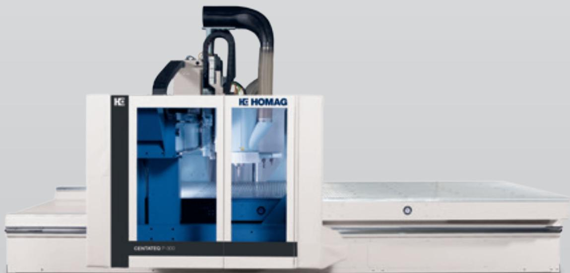
**CENTATEQ P-300:** Bearbeitungszentrum mit Alu-Rastertisch für die Bearbeitung von technischen Bauteilen, Formteilen und Nesting
