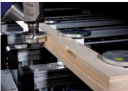
Rahmenteile spannen und profilieren
