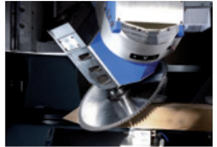
Schifterschnitt mit großer Schnitttiefe für Rahmenteile
