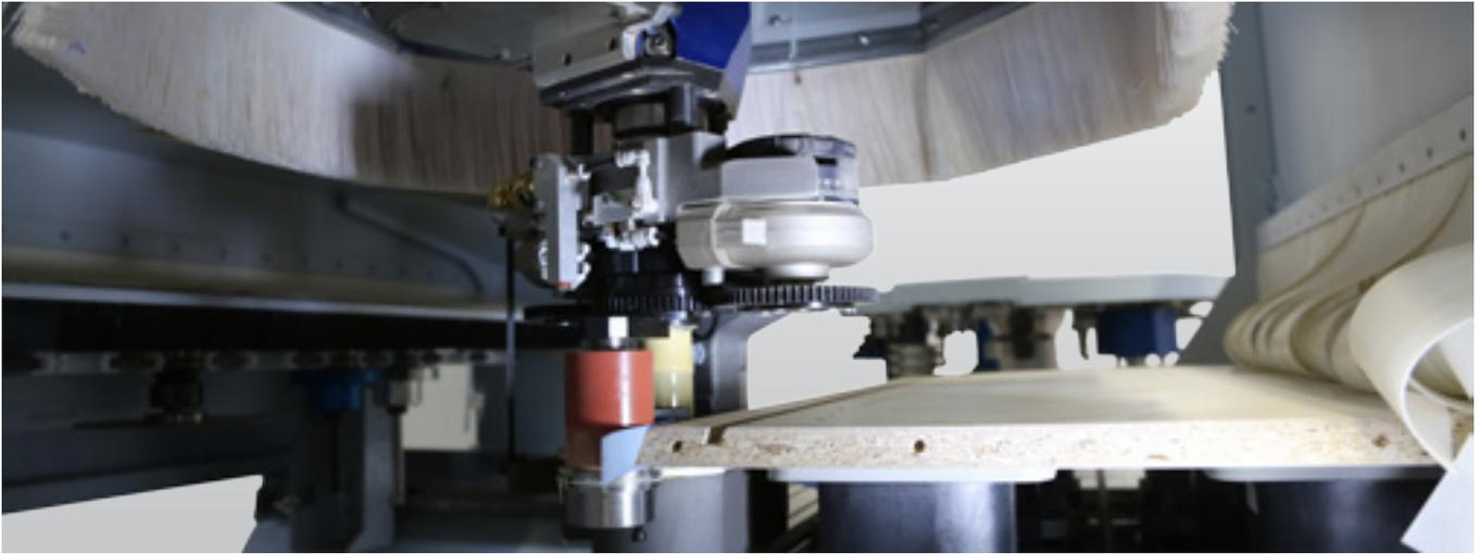
**easyEdge und DRIVE5C:** Die perfekte Kombination von Kantenverleimung mit leistungsstarker 5- Achs- Bearbeitung. Die DRIVE5C+ Spindel nimmt das easyEdge Aggregat direkt aus der PickUp Station im seitlichen Linearwechsler, Kante zuführen, und los geht's.
