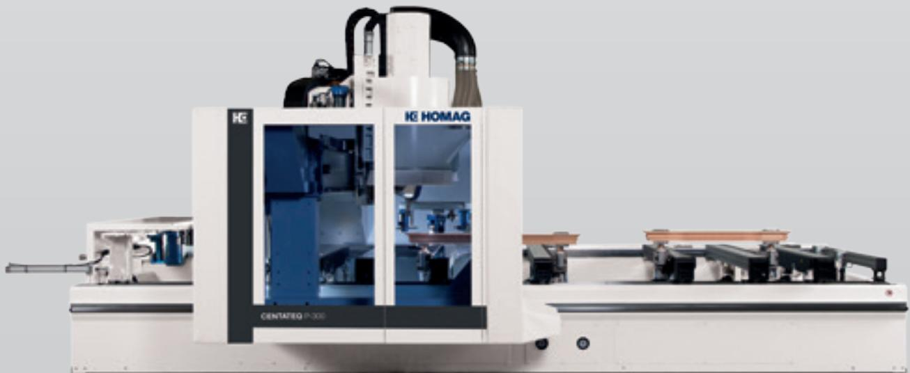
**CENTATEQ P-300:** Bearbeitungszentrum mit 3- Stufen- Spannsystem für die Fensterfertigung
