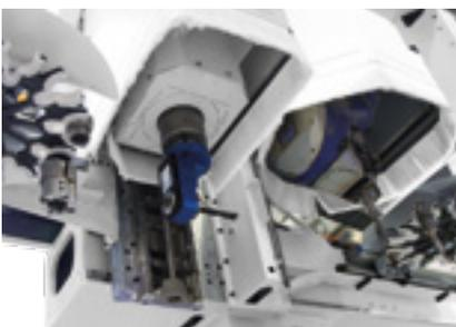
**Schneller Werkzeugwechsel:** Durch den Aufbau von zwei Frässpindeln können die Span-zu-Span-Zeiten reduziert und die Produktivität gesteigert werden. Während eine Spindel fräst, wechselt die zweite Spindel das Werkzeug für die nächste Bearbeitung ein.
