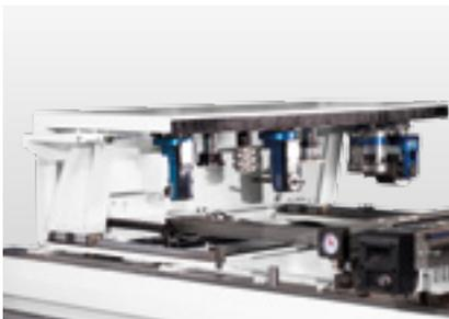
**Linearwechsler:** Zusätzliches Werkzeugwechselmagazin mit 8/9 Plätzen und integriertem Werkzeugübergabepplatz, seitlich angebaut. Das Magazin nimmt auch den Pick-up-Platz für das optionale easyEdge-Aggregat auf.
