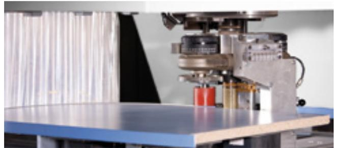
**easyEdge Kantenanleimaggreat:** Die kleinste Kantenanleimmaschine der Welt – preiswert, einfach und effizient. Die universale Lösung für die Bekantung von kleinen Werkstückmengen mit Furnierkanten, ABS-Kanten, PP-Kanten, Melaminkanten und PVC-Dünnkanten.
