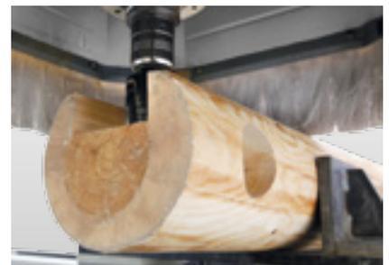
**Blockspanner:** Angepasste Blockspannvorrichtung für Rundholzelemente.
