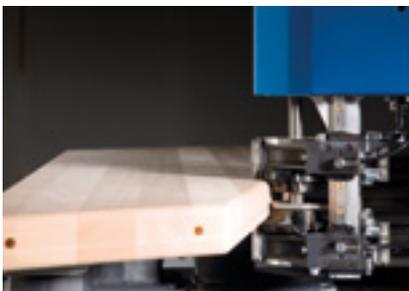
**Pneumatikschnittstelle:** Die patentierte Schnittstelle mit 3-fach-Abstützung an allen C- Achsen und 5-Achs- Köpfen ermöglicht den Einsatz getasteter Aggregate z.B. für exaktes Abrunden oben und unten unabhängig von Dickentoleranzen.
