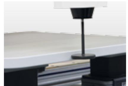
**Messtaster:** Tastsystem zur Ermittlung der für die Bearbeitung relevanten Istmaße in X,Y, Z mit automatischer Korrekturverrechnung im Bearbeitungsprogramm.
