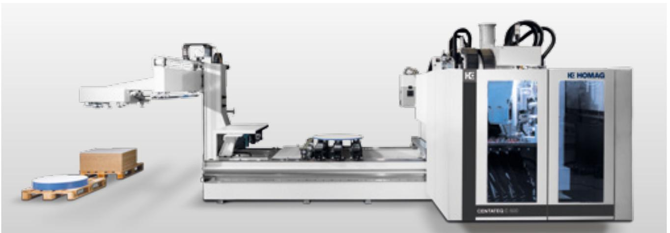
**Anbaubeschicker TBA:** Einfacher und platzsparender Einstieg in die Automatisierung durch den seitlich an die Maschine angebauten TBA-Beschicker. Sicheres Handling, präzises Anlegen und integrierte Werkstückreinigung. Einfachste Bedienung und Programmierung direkt über das woodWOP Bearbeitungsprogramm.
