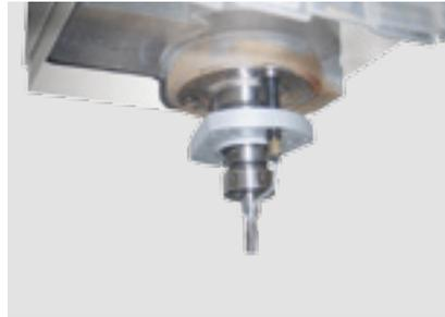
**Minimalmengenschmierung:** Aluminium bearbeiten mit Minimalmengenschmierung durch das Aggregat oder über ein externes Sprührohr an der Spindel für werkzeugschonenden Einsatz.
