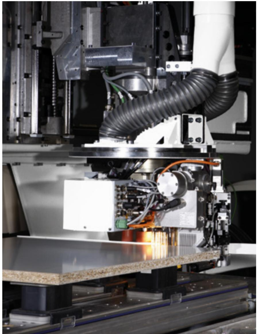
laserTec Formteilebekantung mit Nullfuge
