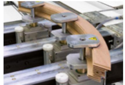
**3-Stufen-Spanner:** Hochsteife 3-Stufen-Spanner mit großer Spannhöhe zur präzisen Komplettbearbeitung von Fenster- und Haustürteilen ohne nachträgliches Umfäzen.
