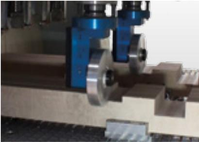
**Synchronbearbeitung:** Synchrone Bearbeitung von 2 in festem Abstand auf dem Tisch gespannten Werkstücke für maximale Leistung durch 2 Frässpindeln mit gleich bestückten Werkzeugwechslern.
