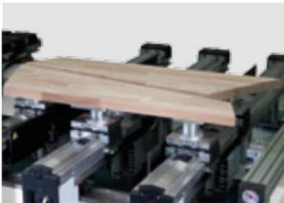
**movePart:** Automatisches Auseinanderfahren nach dem Auftrennen im Programmablauf für Komplettbearbeitung.
