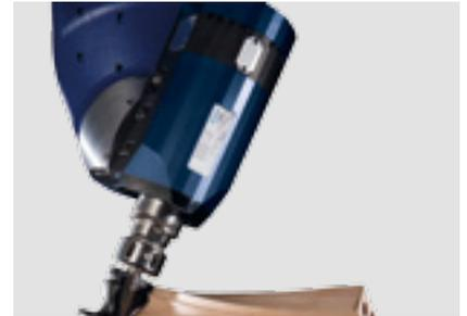
**DRIVE5C+ Fünf-Achs-Frässpindel:** Formteilebearbeitung mit hoher Teilehöhe durch kartesische Anordnung und mit Hochleistungsfräsen durch beidseitig gelagerte Spindel bis 18,5 kW.
