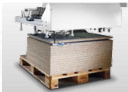
**Greifertechnik mit System:** Integrierte Sensorik verhindert Fehler durch aneinander haftende Teile und stellt sicher, dass diese richtig aufgenommen werden.
