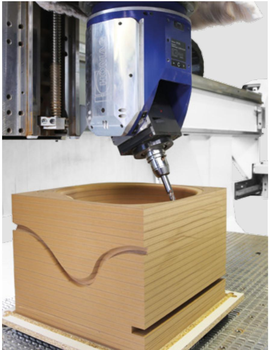
Fräsbearbeitung von Bauteilen mit großer Z- Höhe
