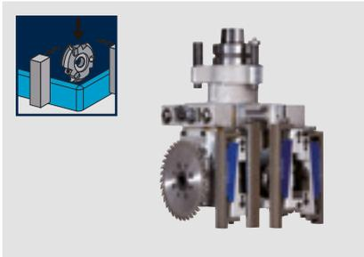
**Kombi-, Kapp- und Eckenrundungsaggregat:** Oftmals werden bereits bekantete rechteckige Werkstücke auf einem Bearbeitungszentrum nachbearbeitet um z. B. Abschrägungen oder runde Konturen zu fertigen. Für die Nachbearbeitung bietet das patentierte Aggregat neben dem getasteten Ablängen der Kantenüberstände auch eine präzise Eckenrundung von Kanten bis zu einer Stärke von 3 mm an einer 90° Werkstückecke.
