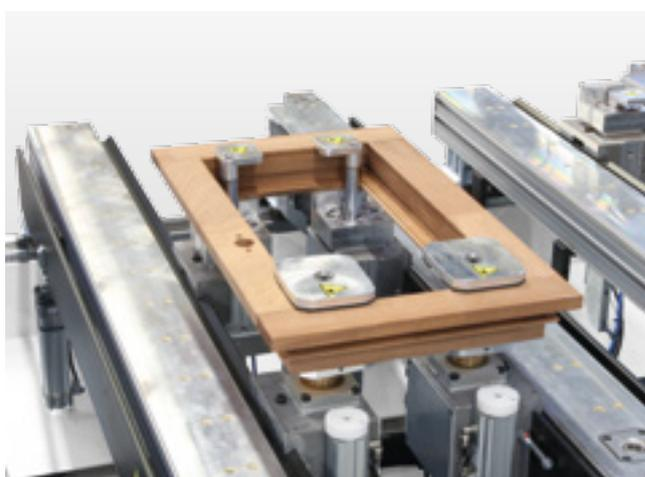
**Rahmen umfräsen:** Auch für die klassische Rahmenfertigung geeignet: Mit Schwenkspannelementen können Fensterflügel einfach eingelegt, ausgerichtet und gehalten werden.
