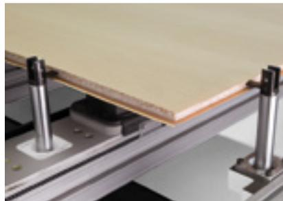
**Bolzen mit Endlagenabfrage und für Deckschichtüberstand:** Anschlagbolzen mit Endlagenüberwachung zum Schutz von Werkzeugen, Aggregaten und Maschinenbedienpersonal. Wechselanschläge speziell für Werkstücke mit Deckschichtüberstand.
