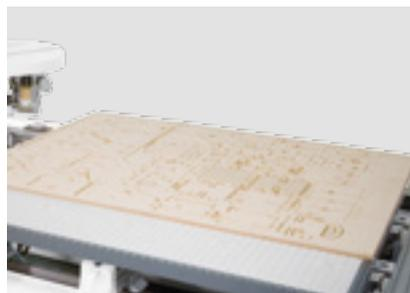
**Matrix-Adapterplatte:** Hochflexible Spannsysteme bieten auch bei filigranen Werkstücken eine sichere Fixierung. Mit der Matrix-Adapterplatte können auch auf einer Konsolentischmaschine Formteile im Nesting-Verfahren verschnittoptimiert „zugeschnitten“ werden.
