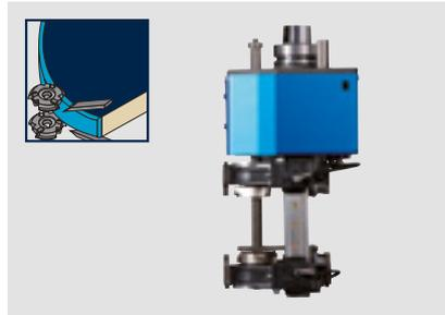
**Kombi-Bündigfräs-Ziehklingenaggregat:** Kombinationsaggregat zum Bündigfräsen des Kantenüberstands und zur Ziehklingennachbearbeitung um die Messerschläge und andere Unebenheiten am Kantenprofil zu entfernen. Die dreiseitige Tastung des Aggregates gleicht Werkstück- und Kantentoleranzen aus und garantiert eine hohe Bearbeitungsqualität.
