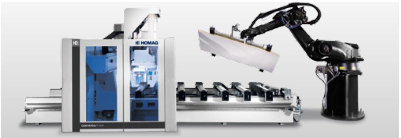
**Roboterhandlungssysteme:** Werkstückhandling ohne Grenzen mit unterschiedlichsten Lagebildern, Lageplätzen, Ausrichten, Wenden. Zusatzfunktionen wie z. B. Etikettierung, Lagevermessung, Reinigung, lassen sich integrieren.
