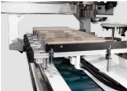
**Linearführung und Einlegehilfen:** Einfaches Handling durch Konsolen mit hochpräzisen Linearführungen und robusten Einlegehilfen mit zwei Pneumatikzylindern. In den Konsolen sind Vakuum- und Druckluftanschlüsse für Pneumatikspanner und Spannschablonen integriert.
