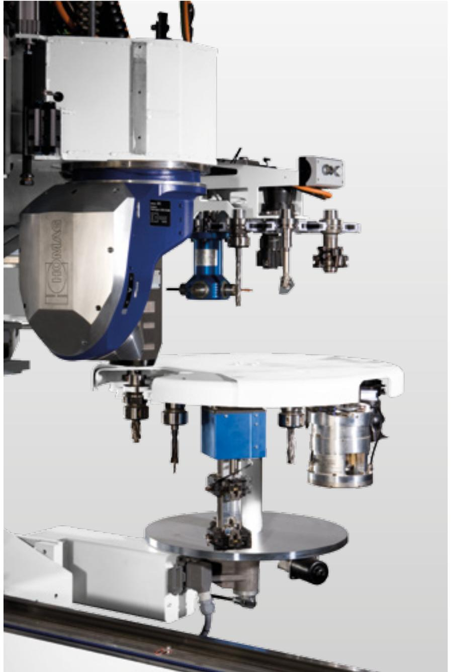
**Werkzeugwechsler:** Werkzeugspeicher mit bis zu insgesamt 99 Plätzen bieten die Grundlage für den flexiblen Einsatz unterschiedlicher Werkzeuge und Aggregate auch mit großen Durchmessern von bis zu 200 mm. Sägeblätter können sogar einen Durchmesser von 350 mm aufweisen für große Schnitttiefen auch bei Schifterschnitten (14-fach oder 18-fach Wechsler).
