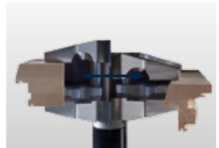
**Freies Einspannen:** Die Greifeinheit und Spanntechnik sorgen für maximale Flexibilität bei der Bearbeitung. Die Bauteile lassen sich frei in allen Richtungen spannen, auch beim Umspannen – freie Einspanntiefe, freie Position der Spannung, auch im Falz.
