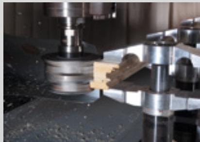
**Leistungsfähige Frässpindeln und unabhängiger Betrieb:** Hohe Leistung durch gleichzeitige Bearbeitung an beiden Tischen und flüssigkeitsgekühlte Frässpindeln mit Vektorregelung.
