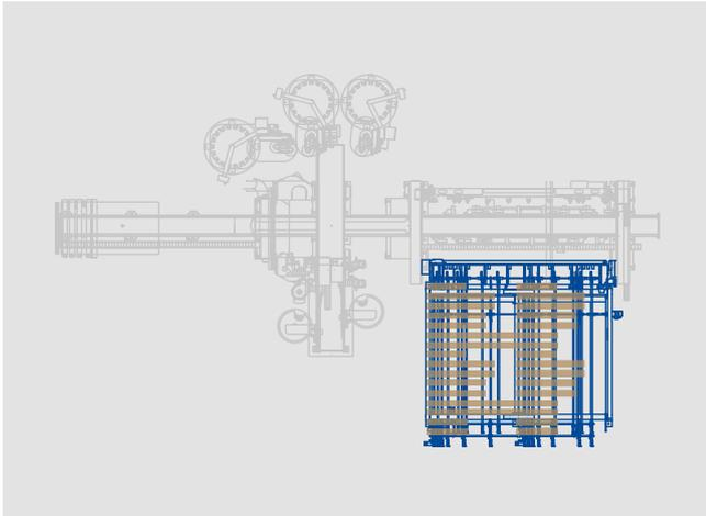
**Verlängertes Einlauf/Auslaufband:** Verlängerte Autonomie durch höhere Pufferkapazität in Ein- und Auslauf – bis zu mehreren Stunden.
