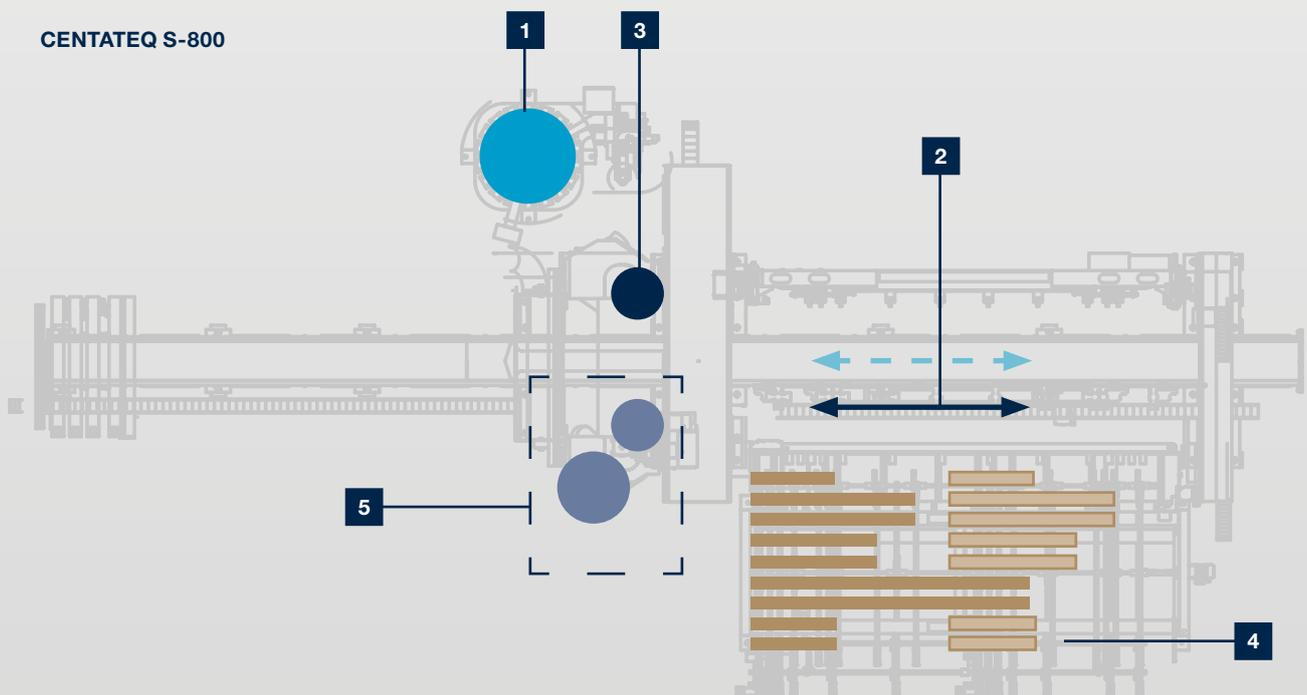
**1** Werkzeugwechsler: ToolTower Werkzeugwechsler mit 36 oder 72 Speicherplätzen
