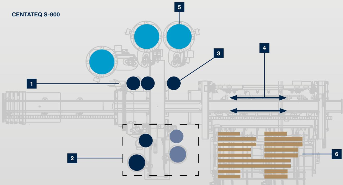
**1** Profilsplitting-Einheit: 2 Frässpindeln in kurzem Abstand mit einem jeder Spindel zugeordneten ToolTower
