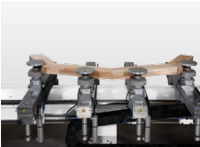
**Bogenelemente:** Die Komplettbearbeitung von Bögen mit einem Stichmaß von bis zu 1.300 mm in einem Stück reduziert die Fertigungszeiten und den manuellen Aufwand (kein Verputzen an den Stößen notwendig). Selbstverständlich inklusive der passenden Glasleiste.
