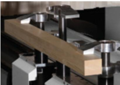
**Wegschwenkbare Spannerplatten:** Die Spannerplatten können im Programm weggeschwenkt werden. So können, unabhängig von der Position der Spannelemente, alle Bohrungen und Ausfräsungen bearbeitet werden.
