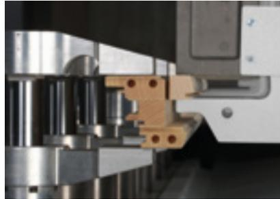
**Glasleiste integriert:** Mit dem Greifsystem lässt sich auch die Glasleistenfertigung integrieren. Die angefräste Leiste wird ausgebrochen und auf dem Auslaufband abgelegt. So bleibt zusammen was zusammen gehört.
