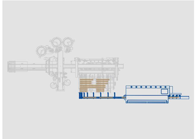
**Winkelübergabe und Anbindung an die Hobelmaschine:** Winkelübergaben und Bandtransporte ermöglichen die Verkettung mit Hobelmaschine oder Kappanlage.
