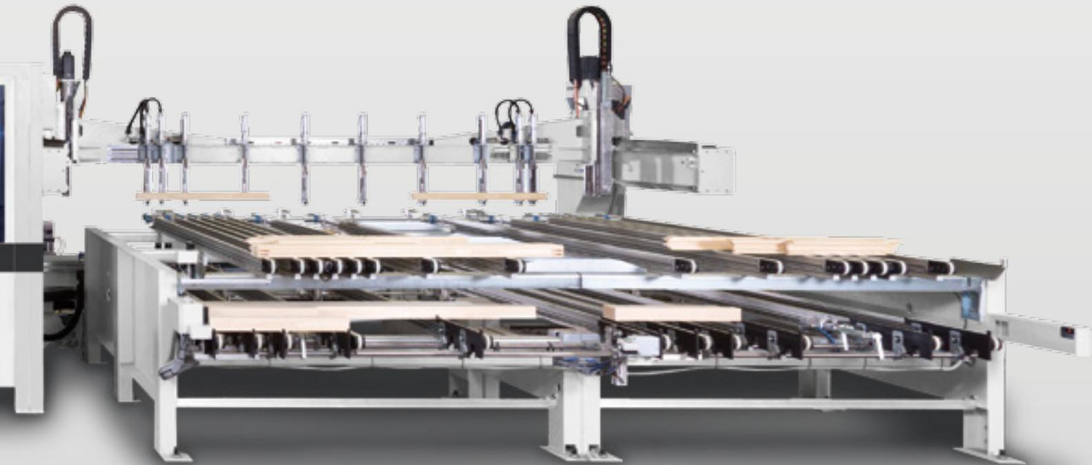
**CENTATEQ S-900:** Bearbeitungszentren für die automatisierte Fensterfertigung vom Einstieg bis zu Anlagenkonzepten zum industriellen Mehrschichtbetrieb. Autonome Bearbeitung durch automatisierte Beschickung und Entnahme der Teile. Durch den Konsolen-Zusatzsch können auch Bögen- und Flächenteile bearbeitet werden. Eine Maschine für alle Bauteile.
