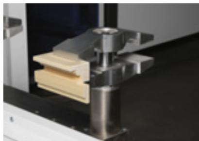
**Kurzteile integriert:** Die Spann- und Greiftechnik ermöglicht auch die Fertigung kürzester Teile ab 120 mm Brüstungslänge.
