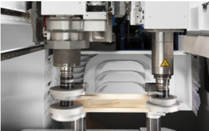
**Profilsplitting effizient:** Zwei Frässpindeln auf einem Träger, die zueinander NC gesteuert verstellbar werden können. Das ermöglicht schon bei kurzen Bauteilen Profilsplitting-Bearbeitung oder das Vorzerspannen und Fertigfräsen.
