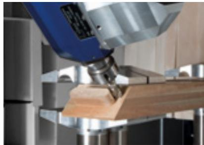
**5-Achs-Technik:** DRIVE5-Frässpindeln mit interpolierender fünfter Achse reduzieren die Aggregatekosten und erhöhen die Flexibilität.
