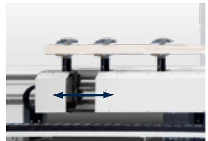
**Programmgesteuert positionierende Spannelemente:** Durch programmgesteuert positionierende Spannelemente und Greifer an der Handlungseinheit werden die Werkstücke immer mit optimalem seitlichem Überstand gehalten.
