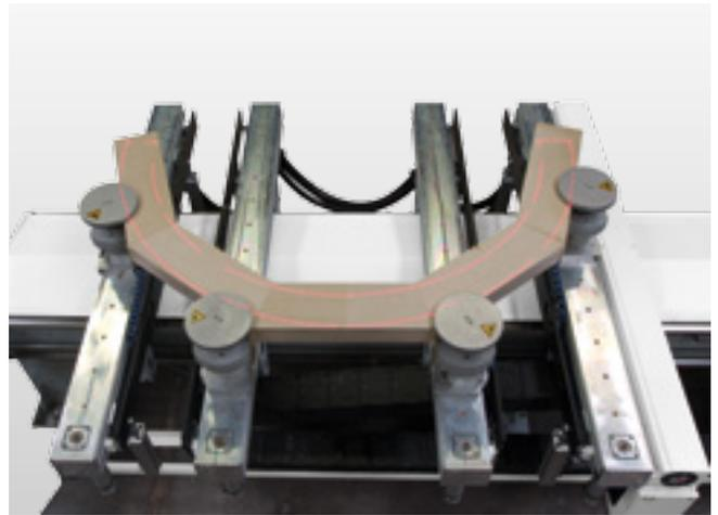
**Projektionslaser:** Für die optimale Ausnutzung des Rohmaterials und sicheres Auflegen werden Spannelemente und Rohteile für die Bogenfertigung mit Hilfe eines Projektionslasers ausgerichtet.
