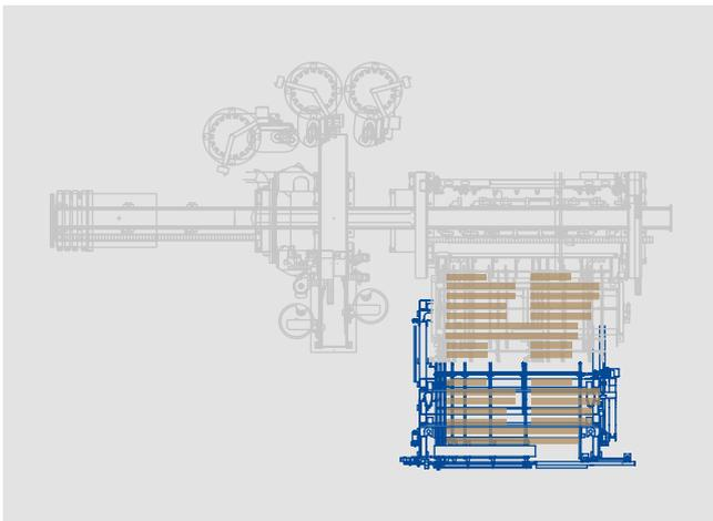
**Hordenwagen mit automatischer Werkstückzufuhr:** Für eine mannarme Fertigung und noch längere Bearbeitungszyklen ohne Bediener.
