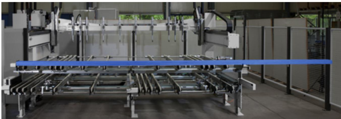
**Von XXS bis XXL:** Von 20 mm bis 150 mm Teilehöhe und von 25 bis 300 mm Teilebreite können im Automatikbetrieb bearbeitet werden. In der Länge sind bis zu 4.200 mm ohne Umgreifen, mit sogar 6.000 mm automatisch möglich.
