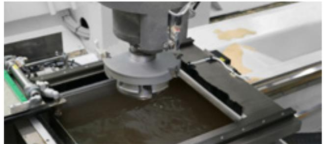
**Werkzeugreinigungssystem:** Saubere Werkzeuge über Nacht. Durch ein in die Maschine integriertes Ultraschallreinigungsggerät können die Werkzeuge ohne manuellen Eingriff gereinigt werden. Das vereinfacht den Schneidplatten-Wechsel und sorgt für lange Standzeiten mit hoher Oberflächengüte.
