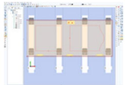
**woodFlex:** Produktionsliniensteuerung für die effektive Abarbeitung von Produktionslisten mit grafischer Teilevisualisierung und -verfolgung am Maschinenbildschirm. So ist klar, welches Teil an welcher Stelle in der Maschine ist. Mit woodFlex ist die Integration in Produktionslinien mit vor- und nachgeschalteten Maschinen möglich (z.B. 4-Seiten Hobel, Kappsäge, ...)
