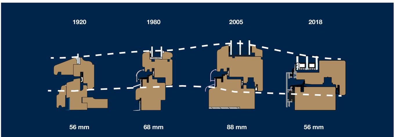
„Slim Fit“ für Fenster: Zurück zu den Ursprüngen: Ansichtsbreiten werden wieder schmal, Querschnitte schlank.
