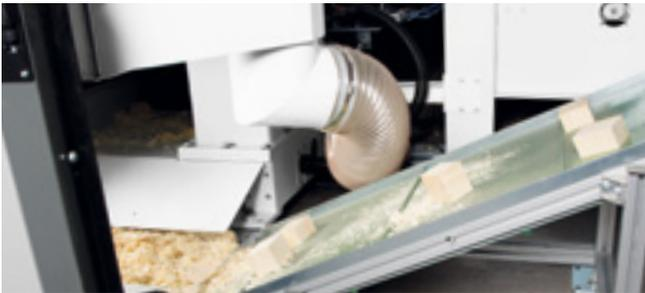
**Steigförderer für Stückabfälle:** Stückabfälle aus der Sammelrinne unter der Maschine können mit einem Steigförderer direkt in einen Behälter oder Wagen gefördert werden.
