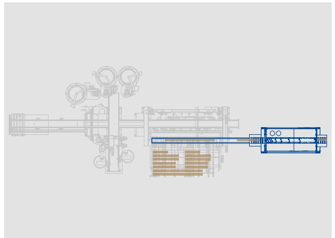
**Auslaufband und Anbindung an die Flutgründierung:** Transportband in Längsrichtung anstelle des Auslaufbands mit direktem Austransport in die Flutgründierung.
