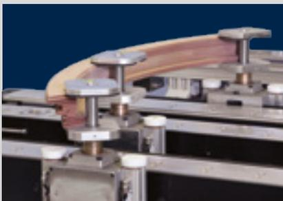
**Spannsysteme für die Fensterfertigung:** Speziell für die Fensterfertigung optimierte Spannsysteme wie z. B. der 3-Stufen-Spanner mit großer Spannhöhe zur präzisen Komplettbearbeitung von Fenster- und Haustürteilen ohne nachträgliches Umfälen.
