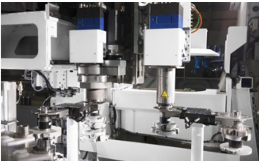
**Gleichzeitiger Werkzeugwechsel:** Jeder der beiden Spindeln ist ein 36- oder 72-fach Werkzeugwechsler mit Vorwechselsystem zugeordnet. So können mit kurzer Zeit, Werkzeuge gleichzeitig in beiden Spindel ausgetauscht werden.
