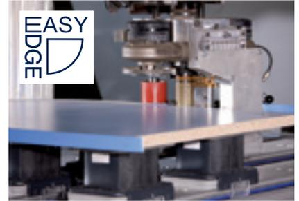
**easyEdge Kantenanleimaggregat** ist die universale Lösung für die Bekantung von kleinen Mengen.
