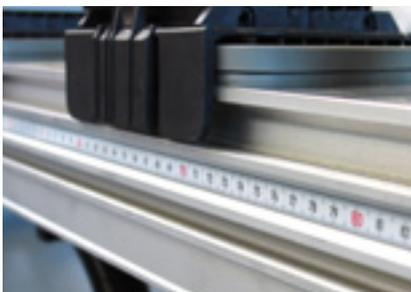
**Maßband** zur Positionierung der Sauger.
