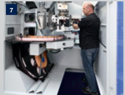
**Einfacher Zugang** – Bohrerwechsel, Service, Nachfüllen von Kleber und Kantenwechsel können bequem von der Vorderseite der Maschine durchgeführt werden.
