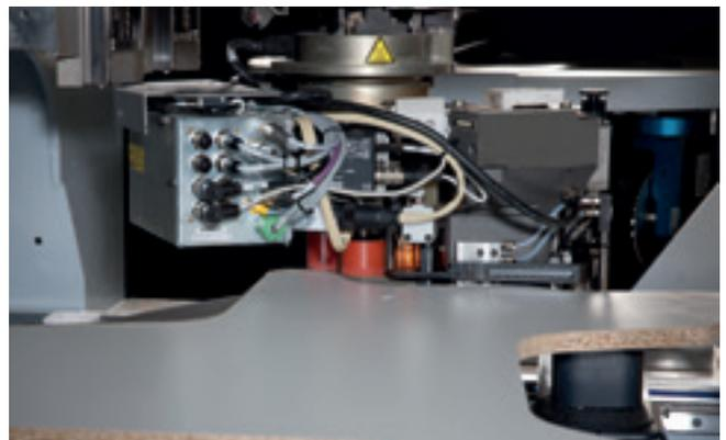
360° Kantenverleimung mit dem powerEdge Kantenanleimaggregat
