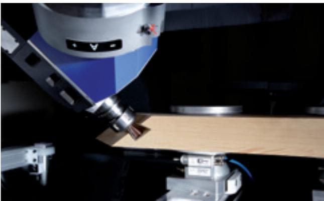
Fräsen einer Gratverbindung für Pfosten-/Riegelkonstruktionen
