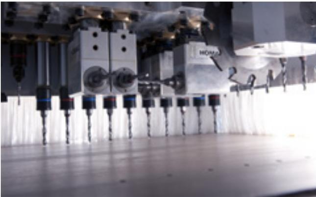
High-Speed-Bohrtechnik mit Nutsäge
