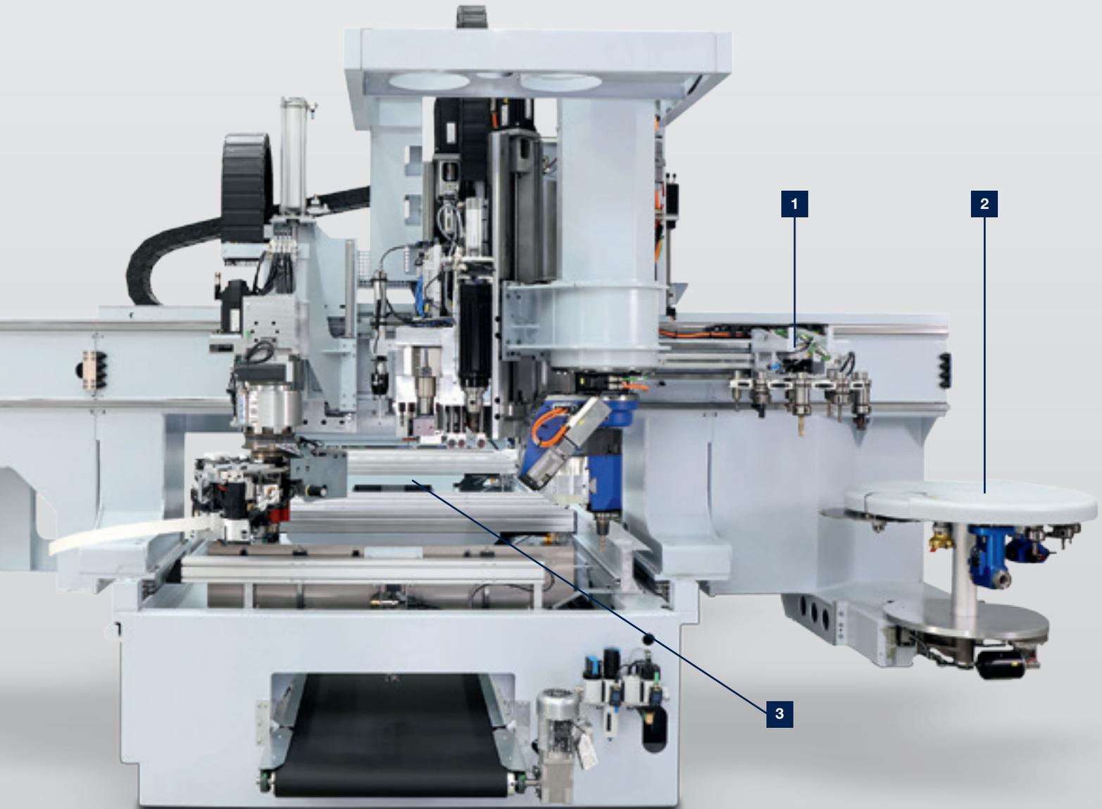
**1** Wechsler an der Spindel mitfahrend für Werkzeugwechsel während des Bohrens oder Kantenanleimens.
