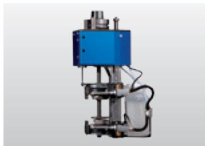
**Bündigfräsaggregat mit Trennmittel** reduziert die Leimrückstände auf dem Werkstück und erübrigt oft die Leimfugenziehklinge.
