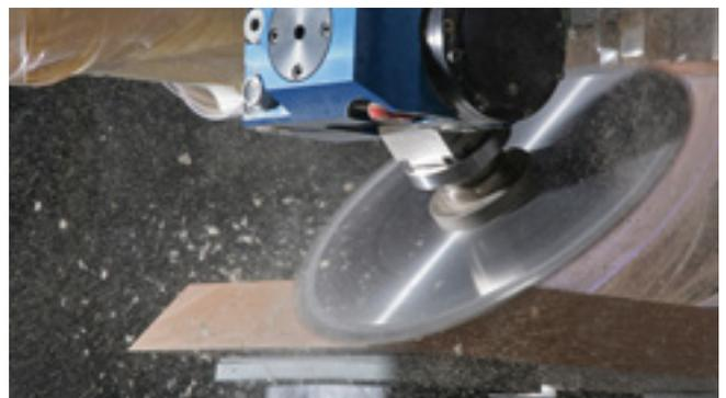
**Sägen, Fräsen, Bohren in jedem Winkel** – **FLEX5+ Aggregat** mit automatischer Winklereinstellung und automatischem Werkzeugwechsel. Ein einzigartiges Aggregat für 4-Achs-Spindeln, das über 90% von 5-Achs-Applikationen abdeckt.
