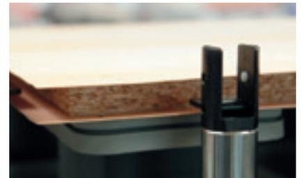
**Anschlagbolzen für Deckschichtüberstand** mit Endlagenüberwachung zum Schutz von Werkzeugen, Aggregaten und Maschinenbedienpersonal.
