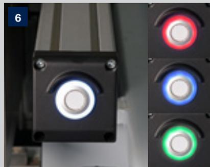
**Taster für den Programmstart** direkt am linken und rechten Anschlagprofil des Maschinentischs. Durch mehrfarbige Leuchtanzeige ist der Spannzustand sofort im Blick.
