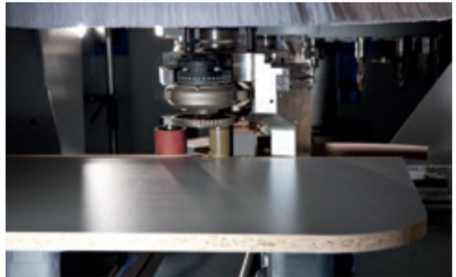
Verleimaggregat easyEdge zum rationellen Anleimen an Formteile
