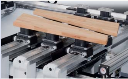
Automatisches Auftrennen und Auseinanderfahren von Treppenstufen für die umlaufende Komplettbearbeitung
