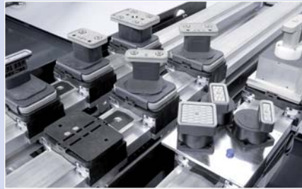
Unterschiedliche Vakuum- und Pneumatikspannelemente garantieren eine exakte Bearbeitung unterschiedlicher Werkstücke und Werkstoffe
