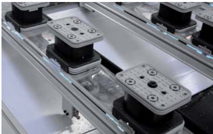
LED-Positioniersystem – das schnellste und sicherste System gegenüber allen anderen Systemen zum manuellen Positionieren der Vakuumspanner und Konsolen
