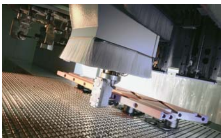
Treppenwangenbearbeitung auf Flex-System
