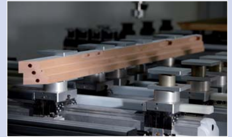
Verfahren der Pneumatikspanner nach der Längsprofilierung von z. B. Fensterkanten in Y-Richtung für eine 5-seitige Bearbeitung
