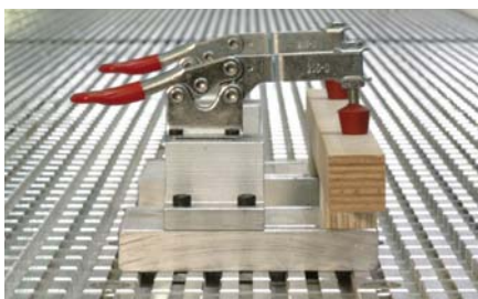
Genuteter Aluminiumrastertisch gewährleistet die präzise Fixierung durch mechanische Spannelemente an jeder beliebigen Stelle
