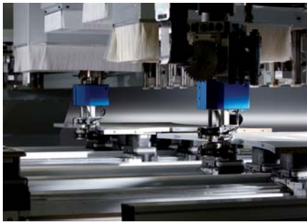
Kantennachbearbeitung von Möbelteilen
