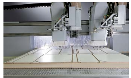
Synchronbearbeitung beim Nesten von Korpusmöbelteilen
