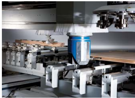
Zeitgleiche Bearbeitung einer Türzarge und eines Türblattes
