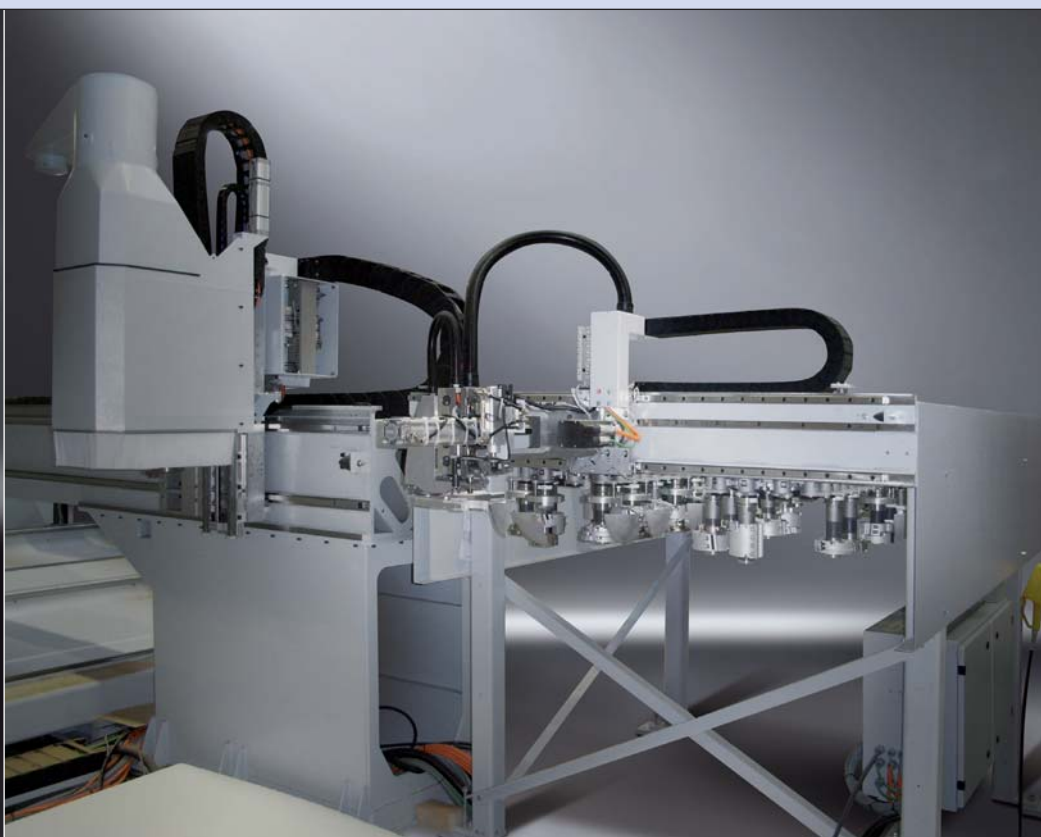
Werkzeugwechselsystem mit 10 - 218 Plätze je Hauptspindel (abhängig von der Konfiguration) für eine höchst effiziente Bearbeitung ohne manuelle Eingriffe
