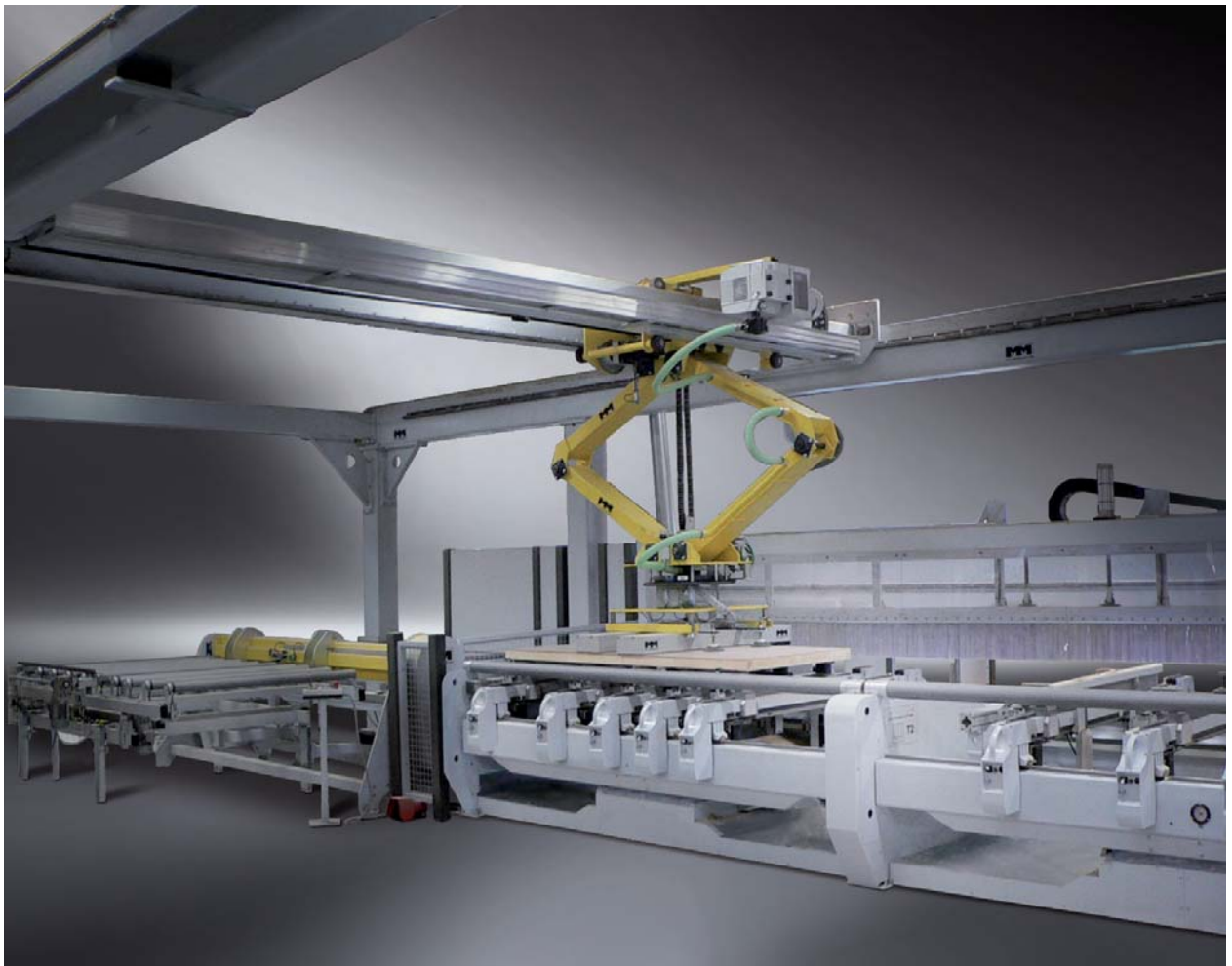
Fertigungszelle inkl. Wendestation, Türblattidentifikation mittels Transponder und automatischer Werkstückreinigung
