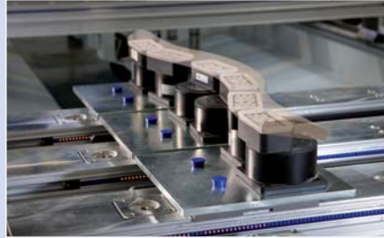
Selbst schmale, geschweifte Teile lassen sich mit dem Maxi-Flex-Spannsystem spannen
