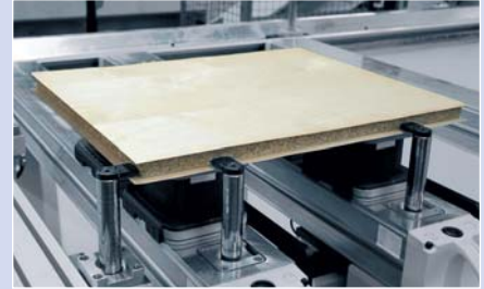
Flexibles Spannsystem: Anschlagbolzen mit Schwenkanschlägen für Werkstücke mit überstehenden Deckschichten (Option)
