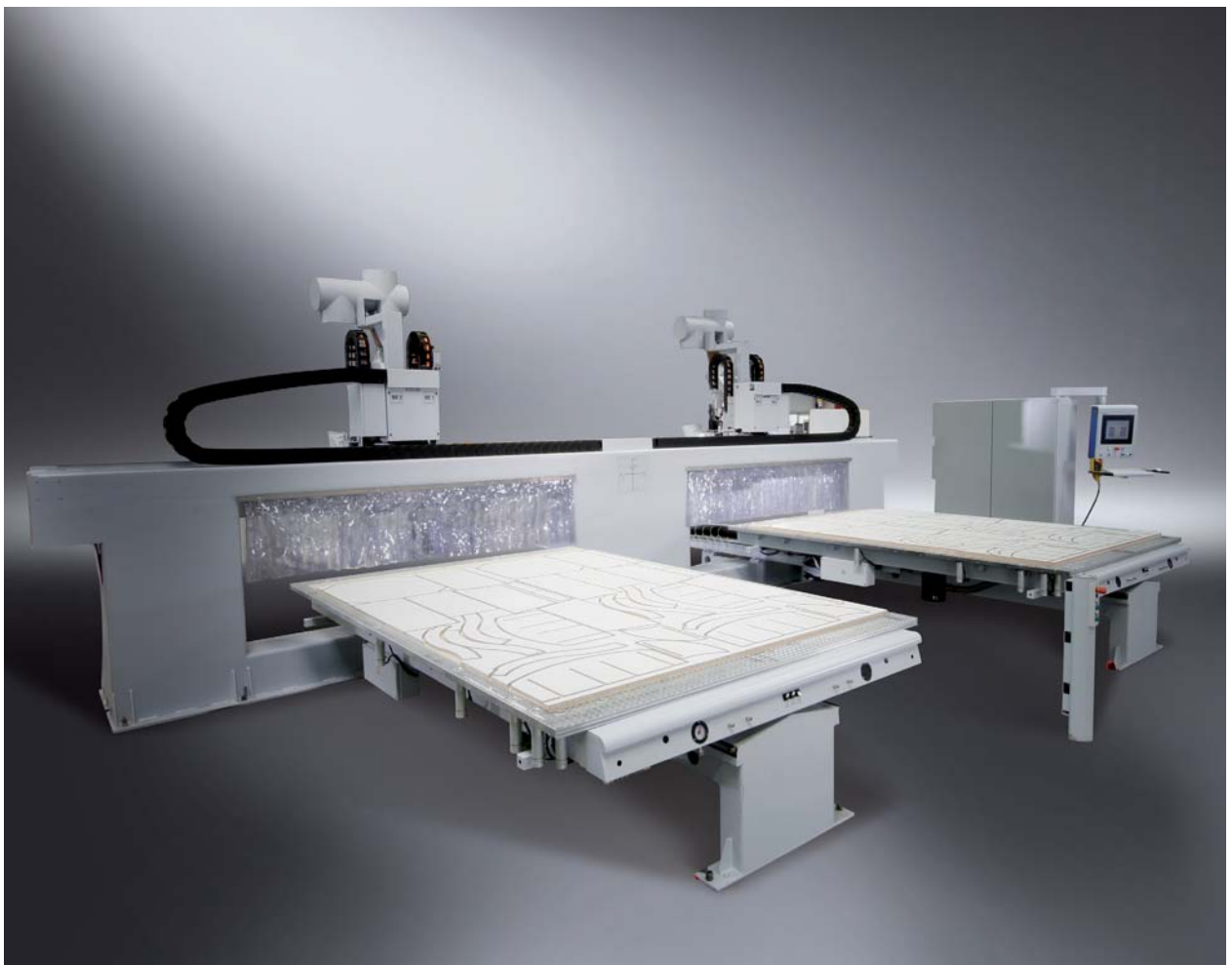
BOF 612 mit zwei unabhängigen Frässpindeln und zwei dreiseitig zugänglichen Rastertischen
