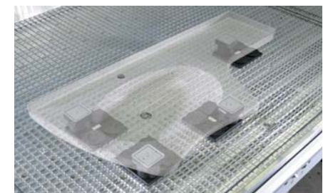
Das Flex-System erlaubt auch das sichere Fixieren von gewölbten Werkstücken wie einem Waschtisch aus Corean
