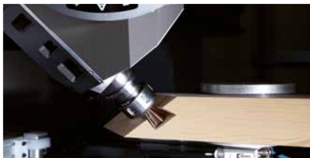
Frézování konstrukčních spojů
