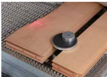
Polohování pomocí laseru , dráha frézy může být zobrazena laserovým křížem
