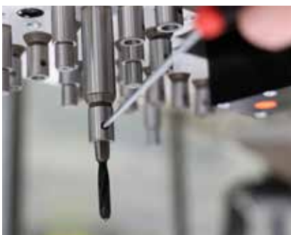
Systém Weldon pro výměnu vrtáků pomocí nástrojů
