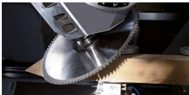
Úhlový řez s velkou hloubkou (kotouč o průměru až 350mm)
