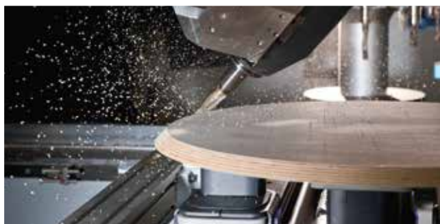
Frézování zkosené hrany na desce stolu
