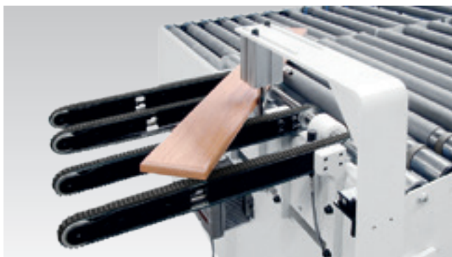
Otočné čepy pro úzké dílce Ovládací senzor.
