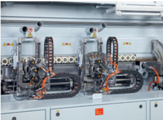
**Multifunktions-Formfräsaggregat MF 60 Servotrim**
