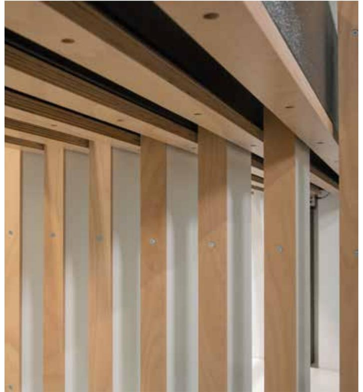
**Pressflächen mit Toleranzausgleich:** Die Presslamellen funktionieren wie eine Einheit, sie sind auf Gummis gelagert und abgefedert. Durch das zeitgleiche Auftreffen der Presslamellen auf den Korpus wird der Druck besonders gleichmäßig verteilt. Toleranzen im Korpus werden besser aufgefangen.
