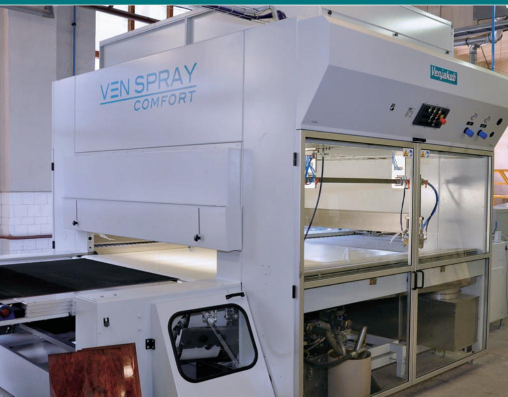
Двойной узел очистки позволяет параллельно работать как с водораствляемыми, так и с органическими ЛКМ.
