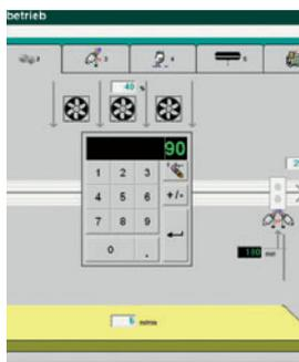
**Настройка по высоте:** Опциональная автоматическая настройка по высоте всех пистолетов-распылителей позволяет быстро перенастраивать их для покрытия изделий разной высоты. Система управляется с центрального пульта.
