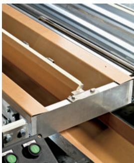
**Надёжно:** При нанесении абразивных, маловязких или содержащих отвердители наполнители систем лака и стойких красок, ракельная система позволяет получить чистосортный возврат. Возвратно-поступательно движущийся ракель обеспечивает стабильно высокую рекуперацию.
