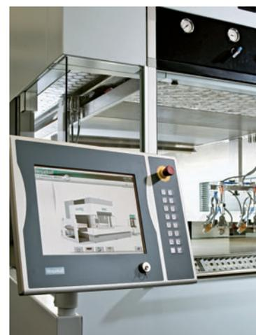
Система управления может быть поставлена в двух версиях. Как пульт управления с промышленным персональным компьютером на базе операционной системы Windows и отображением посредством сенсорного экрана расположенного на высококачественном кронштейне или на двери распределительного шкафа. Как альтернатива предлагается программируемый логический контроллер Siemens с визуализацией через сенсорный монитор, установленный на корпусе станка или на двери распределительного шкафа.
