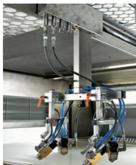
**Быстросменная система:** Пистолет-распылитель для подключения к материальной линии присоединяется к линейной оси с помощью отдельных быстросъёмных зажимов. Это позволяет быстро демонтировать комплект пистолетов-распылителей и установить на его место другой набор для продолжения процесса производства.
