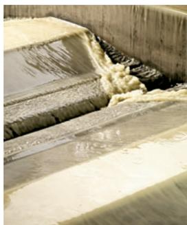
**Влажное воздухоотведение:** гарантирует наилучшие результаты особенно в случае его использования в высокопроизводительных линиях финишной отделки. Боковое расположение водяных завес предусмотрено для получения превосходной циркуляции воздуха. Отделение лакового шлама происходит в шламоотделителе или в центробежном сепараторе.
