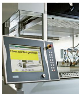
**Доступность:** Удобная система диагностики незамедлительно и надёжно выводит на дисплей информацию о состоянии машины. Дополненная удаленной службой поддержки и высокоэффективным сервисом, она сводит время простоя к минимуму.
