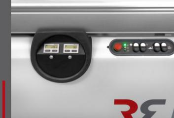
Bedieningspaneel Z500 EL met optionele digitale aflezing van hoogte en hoek van het zaagblad voor meer comfort en een hogere precisie.
