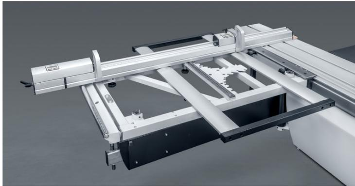
Grote oplegtafel met schuinstelbare aanslagbalk. Het indexsysteem met lengtecorrectie vergemakelijkt het nauwkeurig zagen van hoeken en verstekken. De optionele digitale aflezing kan dankzij een uniek systeem over de volledige lengte van de stevige aanslagbalk gebruikt worden (0-3355 mm).
