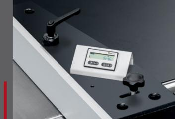
Robuuste gietijzeren parallelgeleider met fijnregeling voor een nauwkeurig zaagresultaat. De optionele digitale aflezing verhoogt het gebruiksgemak en de nauwkeurigheid (+/- 0.1mm). Voor de verwerking van extra grote platen kan de aanslag eenvoudig onder het tafelloppervlak worden gedraaid.
