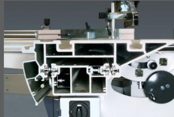
Zeër brede, volledig geanodiseerde rolwagen. Het Robland lagersysteem met harde kogels en geharde stalen ronde baren met automatisch reinigingssysteem zorgt voor een soepele loop. Het ontwerp van de profielen zorgt voor een zeer hoge torsie- en vormstijfheid, waardoor de rolwagen probleemloos jarenlang zware lasten kan dragen.
