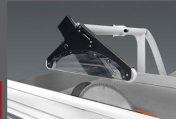
Voor een optimale veiligheid en stofafzuiging past de overhangende zaagkap zich automatisch aan in functie van de hoogte van het werkstuk. De arm is eenvoudig weg te draaien. De schuinstaande steunarm (bij X1 en X3) laat het doorzagen toe van langere werkstukken met een breedte tot 850 mm.
