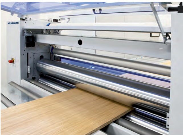
Kaschierkalender mit einem Walzenpaar für das Verpressen von belemten Werkstücken mit aufgelegten Beschichtungsstoffen.
