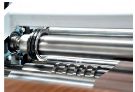
Schneideinrichtung Kreis- und Gegenmesser sorgen für saubere, scharfe Schnittkanten der unterschiedlichen Bahnen
