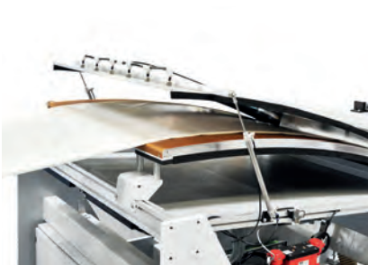
Kühlplatte mit Trockenluftversorgung Entzug der Wärme des aufgetragenen Klebstofffilms
