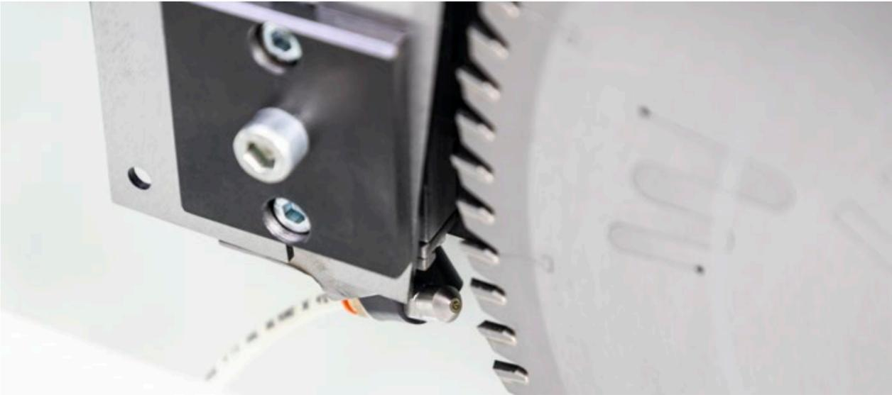
Minimalmengen-Kühlschmiereinrichtung | Txx97
