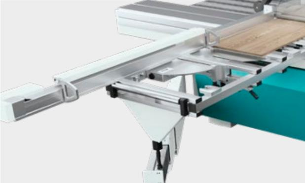
Gesteuerter Längenanschlag (4. Achse) | T7774
