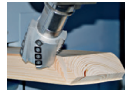
Herstellen eines Zapfen
