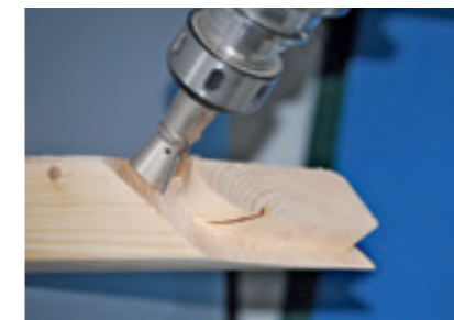
Schwalbenschwanz am Schifter
