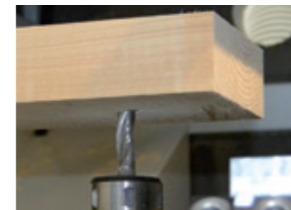
Zapfenloch-Fräsung mit Unterfluraggregat
