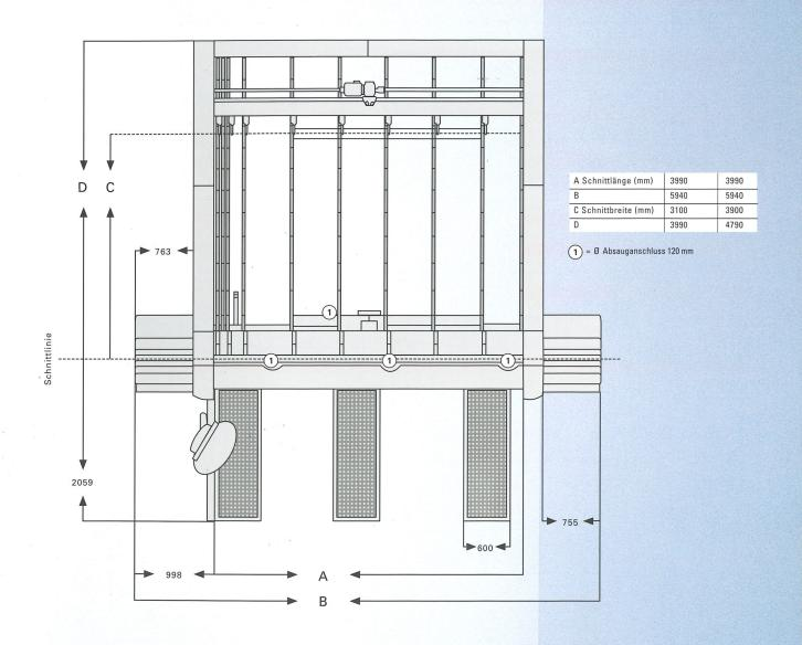
Für kleine Werkstücke oder um Platz zu schaffen lassen sich die Auflagentische verschieben (optional). Die pneumatisch angesteuerte Winkelanpressvorrichtung, geführt auf oberflächengehärteten Prismenführungen, stellt einen ständigen Kontakt von Werkstück und Anpressrolle her und erzeugt so einen winkligen Schnitt bei langen Werkstücken. Die Vorrichtung ist auch bei dünnen Plattenwerkstoffen einsetzbar.
