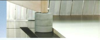
Die pneumatisch angesteuerte Winkelanpressvorrichtung hält Werkstücke sicher in Position und sorgt dadurch für einen exakten Schnitt, auch bei langen Werkstücken.
