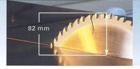
Bei einem Sägeblattdurchmesser von 350 mm sorgt der Sägeblattüberstand von 82 mm für eine saubere Schnittkante.
