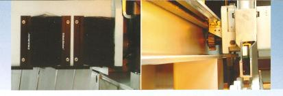
Restschnitteinrichtung für die Aufteilung ohne Restmaß. Die Spannzangen fahren in den ausgesparten Druckbalken ein. Werkstückspannzangen in schwimmender Ausführung gleichen Spannungen innerhalb der Plattenpakete nach oben aus.
