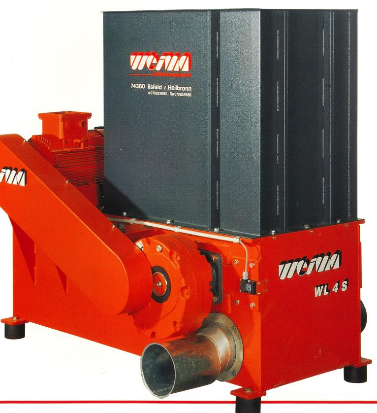
WL 4 – die Maschine mit der Bullenkraft – für Hartholzabfälle wie Buche, Eiche oder Esche.
