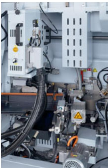
Aggregat zur Aktivierung der Funktionsschicht auf Kanten, für eine Werkstückdicke von 8 - 40 mm.
