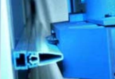
Der automatisch ausweichende Anlagerost verhindert das Zerschneiden der Anlageleisten beim Horizontalschnitt.
