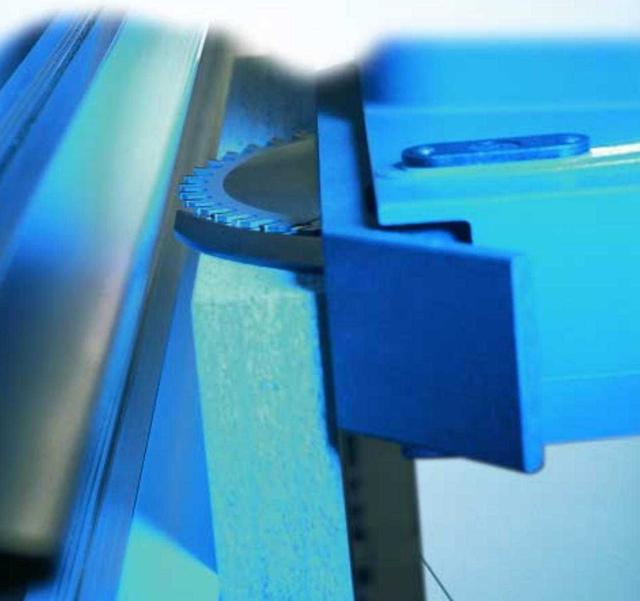
Selbst das Eintauchen des Sägeaggregats in oberster Position ist problemlos möglich. Der Hebel kann einfach nach unten geschwenkt werden. Dadurch sichere Führung in allen Arbeitspositionen. Außerdem: die flexiblen Einsatzmöglichkeiten. Denn die PK 1255 arbeitet ohne Druckluftunterstützung.
