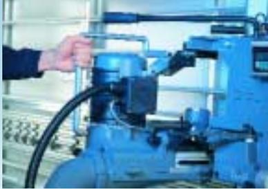
Ausgelegt für Vertikal- und Horizontalschnitte. Letztere sind dabei in jeder Position möglich. Ein großzügig dimensionierter Hebel er-
