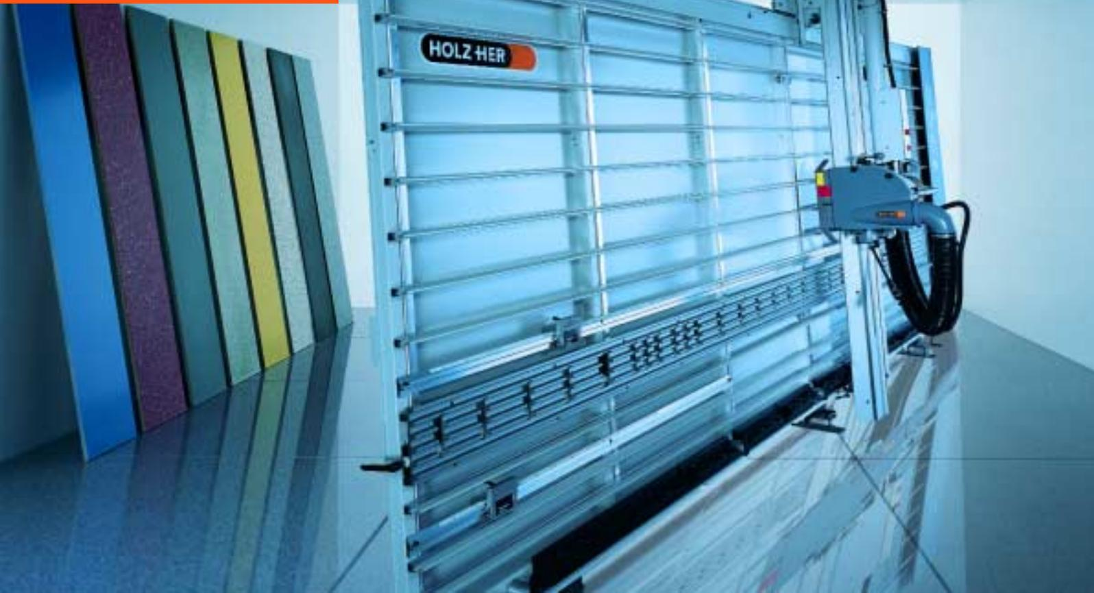
Vertikale Plattensäge PK 1255.
