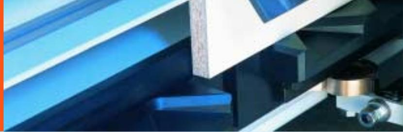
Durchgängige untere Werkstückauflage bis an die Schnittlinie. Vertikale, schmale Teile können nicht kippen oder nach unten durchfallen. Die Anlageleisten aus Kunst-
