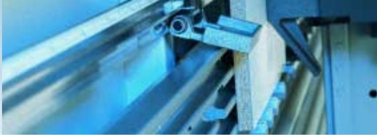
Die mittlere Werkstückauflage ist schnell ausklappbar: einfach Hebel kippen und Werkstück auflegen. Angebracht auf optimaler Höhe für ergonomisches Arbeiten. Der Längsanschlag für vertikale Schnitte wird mechanisch betätigt.
