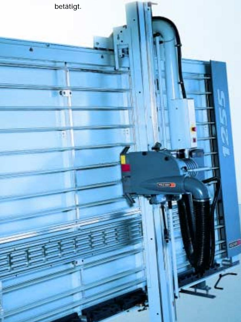
ebenfalls direkt am Grundgestell bzw. am Sägebalken angebracht sind. Damit sind höchste Schnittpräzision und Winkligkeit garantiert. Die hohe Stabilität steht außerdem für eine lange Lebensdauer. Dazu trägt auch der automatisch ausweichende Anlagerost bei, der das Zerschneiden der Anlageleisten im Horizontalschnitt verhindert. Kurz: Mit der PK 1255 erhalten Sie eine technisch ausgereifte und wirtschaftlich optimale Lösung.
